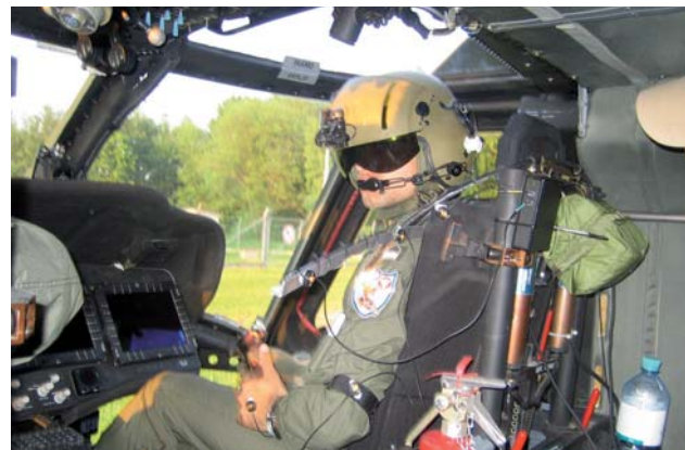
Vibrationsmessungen im „Black Hawk“
